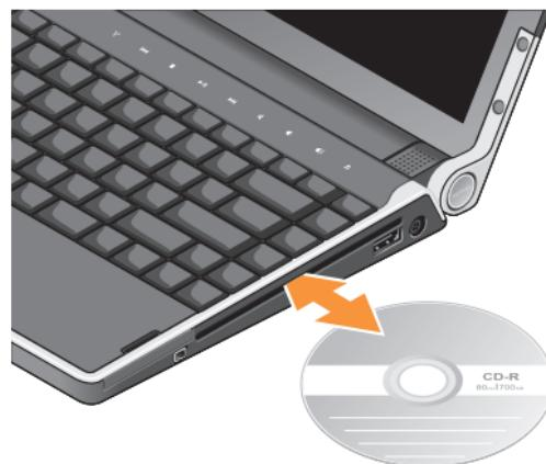
Za izbacivanje diska iz pogona, nježno pritisnite gumb za izbacivanje . Gumb će na nekoliko sekundi treptati za potvrdu prije izbacivanja diska.
